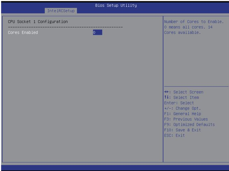
☞ CPU Socket 0/1 Configuration (CPU 插座 0/1 信息)
