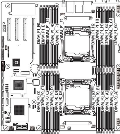
由于 CPU 限制，在以四通道模式安装内存前，请阅读下面的指导说明。
