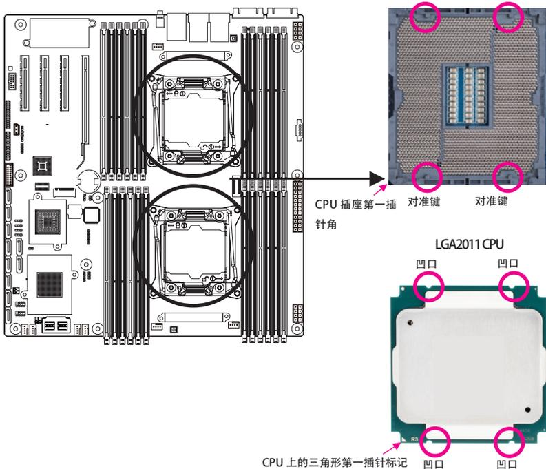
**B. 按下下述步骤将 CPU 正确安装到主板 CPU 插座。**
