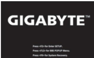
Drücken Sie zum Starten des Betriebssystems kurz die Ein-/Austaste. Mit „-“ rufen Sie GIGABYTE System Recovery auf. Bedienen Sie GIGABYTE Smart Recovery mit der Richtungstaste.
