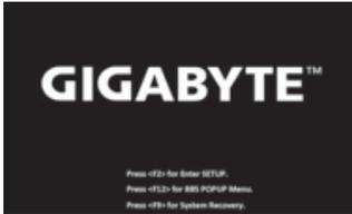
Drücken Sie zum Starten des Betriebssystems kurz die Ein-/Austaste. Mit „-“ rufen Sie GIGABYTE System Recovery auf. Bedienen Sie GIGABYTE Smart Recovery mit der Richtungstaste.
