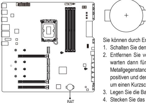
Sie können durch Entfernen der Batterie die Daten im CMOS löschen:
