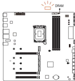
Die Arbeitsspeicher-Status-LED leuchtet auf, wenn das Arbeitsspeichermodul vor dem Startvorgang im falschen Steckplatz installiert wird. Stellen Sie sicher, dass das Arbeitsspeichermodul im richtigen Steckplatz installiert ist. Beachten Sie die Tabelle für Anweisungen zur Installation des Arbeitsspeichers.
