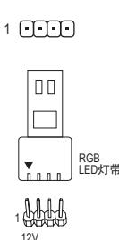
请将RGB LED灯带接至此插座。安装时请将灯带的电源接脚(接口上三角形标示)连接至插座的接脚1 (12V), 不正确安装将会造成灯带烧毁。
