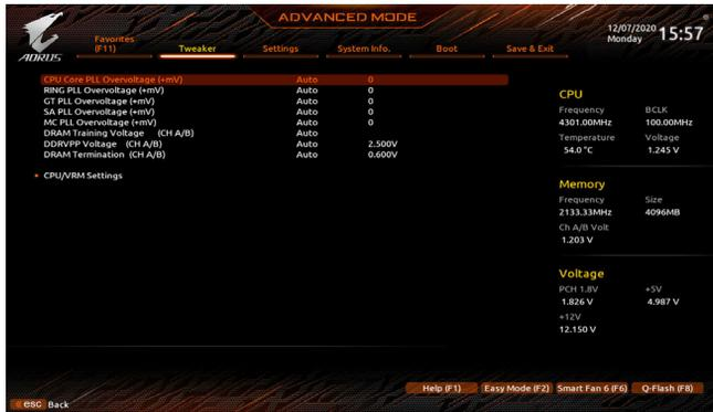
此画面可让您调整CPU内存主要电压值及Load-Line Calibration幅度、过电压保护值、过电流保护值...等设定。
