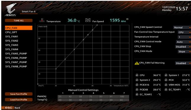
请利用功用键<F6>快速切换至此页面。在此页面您可针对各风扇插座调整转速相关设定，或查看系统/CPU温度。
