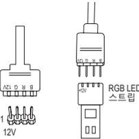
RGB LED 연장 케이블의 한쪽 끝을 헤더에 연결하고 다른 한쪽 끝은 RGB LED 스트립에 연결합니다. 연장 케이블의 검은색 와이어(플러그에 삼각형이 표시되어 있음)가 이 헤더의 핀 1(12V)에 연결되어야 합니다. 연장 케이블의 반대쪽 끝에 있는 12V 핀(화살표로 표시)이 LED 스트립의 12V와 정렬되어야 합니다. LED 스트립의 연결 방향에 특히 주의하십시오. 잘못 연결하면 LED 스트립이 손상될 수 있습니다.
