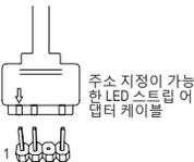
주소 지정이 가능한 LED 스트립 어댑터 케이블의 한쪽 끝을 헤더에 연결하고 반대쪽 끝은 주소 지정이 가능한 LED 스트립에 연결합니다. LED 스트립의 전원 핀(플러그에 삼각형이 표시되어 있음)을 주소 지정이 가능한 LED 스트립 헤더의 핀 1에 연결해야 합니다. 잘못 연결하면 LED 스트립이 손상될 수 있습니다.
