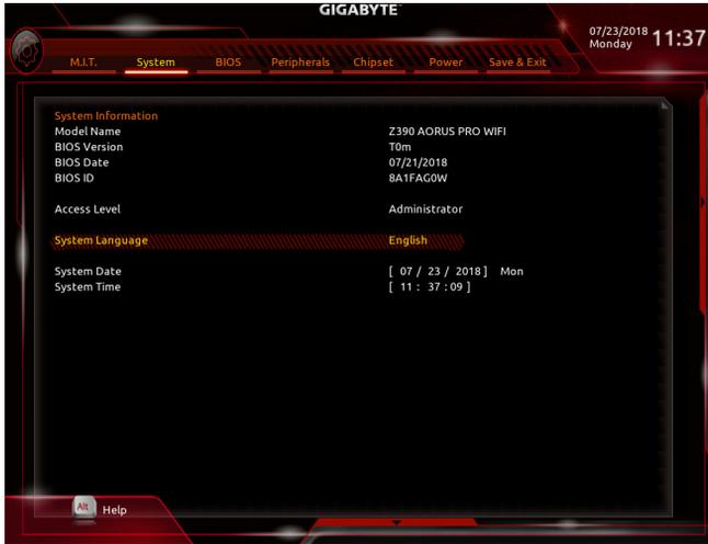
이 섹션에서는 메인보드 모델 및 BIOS 버전 정보를 제공합니다. 또한 BIOS에 사용할 기본 언어를 선택하고 시스템 시간을 수동으로 설정할 수 있습니다.
