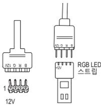
RGB LED 연장 케이블의 한쪽 끝을 헤더에 연결하고 다른 한쪽 끝은 RGB LED 스트립에 연결합니다. 연장 케이블의 검은색 와이어(플러그에 삼각형이 표시되어 있음)가 이 헤더의 핀 1(12V)에 연결되어야 합니다. 연장 케이블의 반대쪽 끝에 있는 12V 핀(화살표로 표시)이 LED 스트립의 12V와 정렬되어야 합니다. LED 스트립의 연결 방향에 특히 주의하십시오. 잘못 연결하면 LED 스트립이 손상될 수 있습니다.
