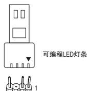
请将可编程LED灯条接至此插座。安装时请将灯条的电源接脚(接口上三角形标示)连接至插座的接脚1, 不正确安装将会造成灯条烧毁。
