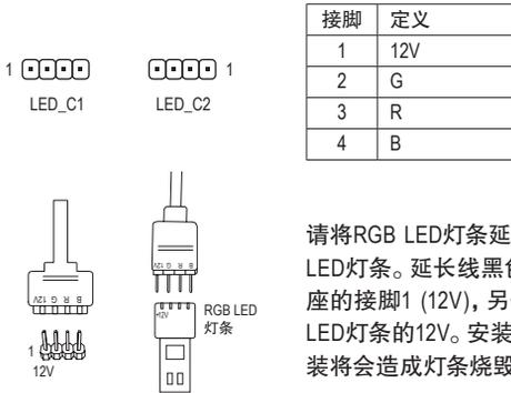
请将RGB LED灯条延长线接口接至此插座，另一端接至RGB LED灯条。延长线黑色线(接口上三角形标示)需连接至此插座的接脚1 (12V)，另一端的12V (接口上箭头标示)需连接至LED灯条的12V。安装时务必注意LED灯条的插法，不正确安装将会造成灯条烧毁。
