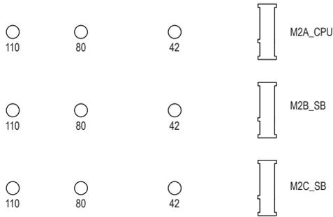
请依下列步骤将M.2 SSD正确地安装于M.2插槽。
