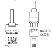
RGB LED 연장 케이블의 한쪽 끝을 헤더에 연결하고 다른 한쪽 끝은 RGB LED 스트립에 연결합니다. 연장 케이블의 검은색 와이어(플러그에 삼각형이 표시되어 있음)가 이 헤더의 핀 1(12V)에 연결되어야 합니다. 연장 케이블의 반대쪽 끝에 있는 12V 핀(화살표로 표시)이 LED 스트립의 12V와 정렬되어야 합니다. LED 스트립의 연결 방향에 특히 주의하십시오. 잘못 연결하면 LED 스트립이 손상될 수 있습니다.
