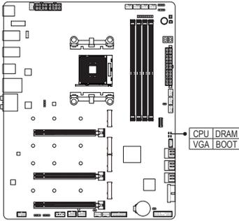
**CPU:** CPU 상태 LED
