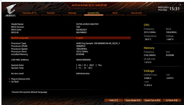
이 섹션에서는 메인보드 모델 및 BIOS 버전 정보를 제공합니다. 또한 BIOS에 사용할 기본 언어를 선택하고 시스템 시간을 수동으로 설정할 수 있습니다.
