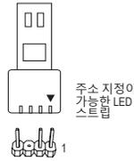
주소 지정이 가능한 LED 스트립을 헤더에 연결합니다. LED 스트립의 전원 핀 (플러그에 삼각형이 표시되어 있음)을 주소 지정이 가능한 LED 스트립 헤더의 핀 1에 연결해야 합니다. 잘못 연결하면 LED 스트립이 손상될 수 있습니다.
