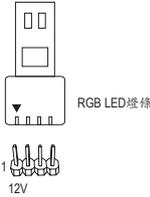
請將RGB LED燈條接至此插座。安裝時請將燈條的電源接腳(接頭上三角形標示)連接至插座的接腳1 (12V)，不正確安裝將會造成燈條燒毀。
