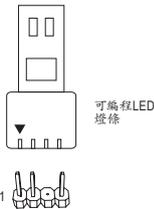
請將可編程LED燈條接至此插座。安裝時請將燈條的電源接腳(接頭上三角形標示)連接至插座的接腳1，不正確安裝將會造成燈條燒毀。
