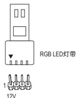
请将RGB LED灯带接至此插座。安装时请将灯带的电源接脚(接口上三角形标示)连接至插座的接脚1 (12V)，不正确安装将会造成灯带烧毁。
