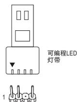
请将可编程LED灯带接至此插座。安装时请将灯带的电源接脚(接口上三角形标示)连接至插座的接脚1，不正确安装将会造成灯带烧毁。
