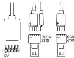
请将RGB (RGBW) LED灯带延长线接口接至此插座，另一端接至RGB (RGBW) LED灯带。延长线黑色线(接口上三角形标示)需连接至此插座的针脚1 (12V)，另一端的12V (接口上箭头标示)需连接至LED灯带的12V。安装时务必注意LED灯带的插法，不正确安装将会造成灯带损毁。若使用RGBW LED灯带(5-pin)，请将延长线接口合并后接上；若使用RGB LED灯带(4-pin)，则仅接上4-pin部份。
