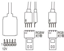
请将RGB (RGBW) LED灯带延长线接口接至此插座，另一端接至RGB (RGBW) LED灯带。延长线黑色线(接口上三角形标示)需连接至此插座的针脚1(12V)，另一端的12V(接口上箭头标示)需连接至LED灯带的12V。安装时务必注意LED灯带的插法，不正确安装将会造成灯带烧毁。若使用RGBW LED灯带(5-pin)，请将延长线接口合并后接上；若使用RGB LED灯带(4-pin)，则仅接上4-pin部份。
