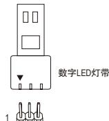
请将数字LED灯带接至此插座。数字LED灯带分为5V及12V，请确认所使用的电压规格，并将DLED\_V\_SW针脚调整为对应的电压。安装时请将灯带的电源针脚(接口上三角形标示)连接至插座的针脚1，不正确安装将会造成灯带烧毁。
