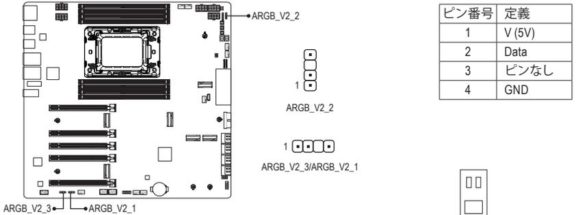
Addressable RGB Gen2 LEDテープをヘッダに接続します。LEDテープ側の電源ピン (プラグの三角印)をaddressable LEDテープヘッダのピン1に接続する必要があります。誤って接続すると、LEDテープが損傷する可能性があります。
