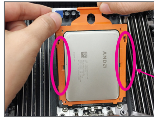
CPU滑轨层沟槽
