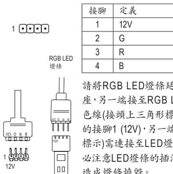
請將RGB LED燈條延長線接頭接至此插座，另一端接至RGB LED燈條。延長線黑色線(接頭上三角形標示)需連接至此插座的接腳1 (12V)，另一端的12V (接頭上箭頭標示)需連接至LED燈條的12V。安裝時務必注意LED燈條的插法，不正確安裝將會造成燈條燒毀。
