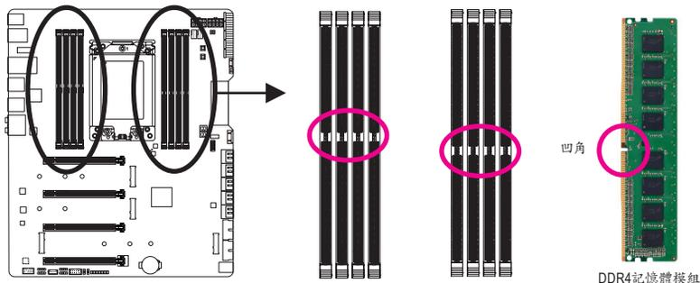
DDR4記憶體模組上有一個凹角，只能以一個方向安裝至記憶體模組插槽內。請依下列步驟將記憶體模組正確地安裝於主機板的記憶體插槽內。
