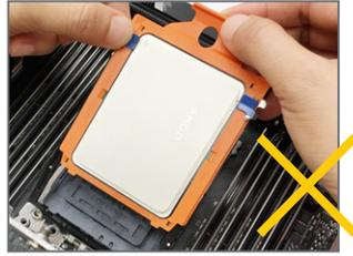
注意! CPU載盤不能處於溝槽外。
