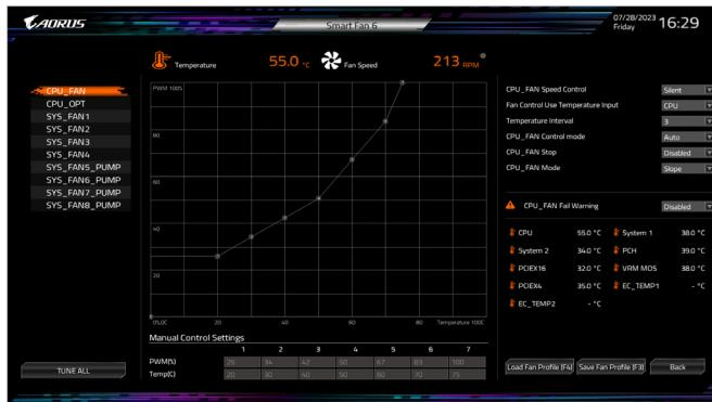
请利用功能键<F6>快速切换至此页面。在此页面您可针对各风扇插座调整转速相关设置，或查看系统/CPU温度。
