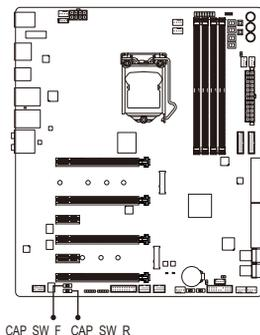
CAP\_SW\_F (前置声道输出)      CAP\_SW\_R (耳机输出)
