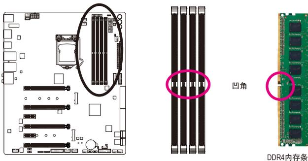
DDR4内存条上有一个凹角，只能以一个方向安装至内存条插槽内。请依下列步骤将内存条正确地安装于主板的内存插槽内。
