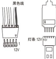
请将RGB (RGBW) LED灯条延长线接口接至此插座，另一端接至RGB (RGBW) LED灯条。延长线黑色线(接口上三角型标示)需连接至此插座的针脚1 (12V)，另一端的12V (接口上箭头标示)需连接至LED灯条的12V。安装时务必注意LED灯条的插法，不正确安装将会造成灯条烧毁。
