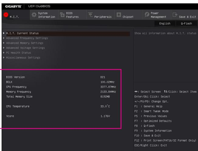
此畫面提供BIOS版本、CPU基頻、CPU時脈、記憶體時脈、記憶體總容量、CPU溫度、CPU電壓等相關資訊。
