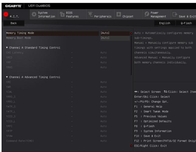
此畫面可讓您調整每一通道記憶體的時序。這些選單只有在「Memory Timing Mode」設為「Manual」或「Advanced Manual」時，才能開放設定。請注意！在您調整完記憶體時序後，可能會發生系統不穩或不開機的情況，您可以載入最佳化設定或清除CMOS設定值資料，讓BIOS設定回復至預設值。
