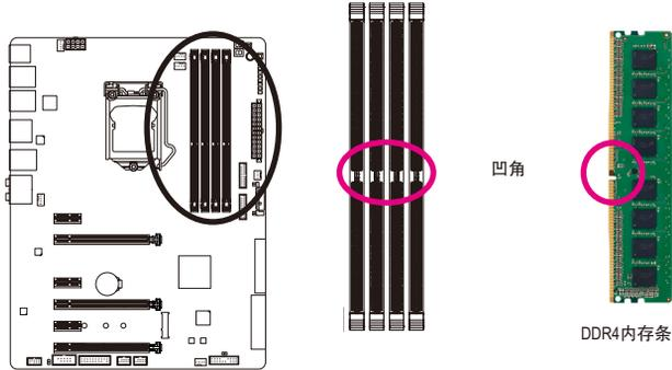
DDR4内存条上有一个凹角，只能以一个方向安装至内存条插槽内。请依下列步骤将内存条正确地安装于主板的内存插槽内。
