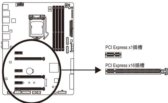
请依下列步骤将扩展卡正确地安装于主板的扩展卡插槽内：
