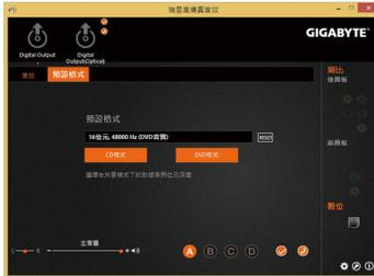
(注) 若是使用主板后方面板的数字输出插座输出数字音频时，请至「Digital Output (Optical)」页面做进一步的设定；若是使用主板内接S/PDIF输出插座(SPDIF\_0) 输出数字音频时，请至「Digital Output」页面做进一步的设定。
