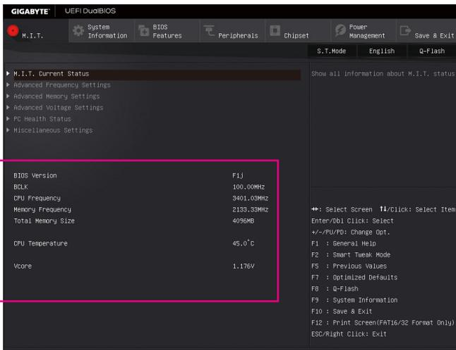
此画面提供BIOS版本、CPU基频、CPU时钟、内存时钟、内存总容量、CPU温度、CPU电压等相关信息。
