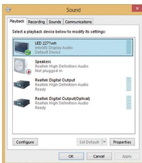
Windows 8.1で、Apps>コントロールパネル>ハードウェアおよびサウンド>サウンド>再生を選択し、Intel(R) Display Audioをデフォルト再生デバイスに設定します。
