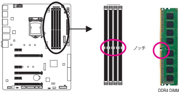
DDR4 メモリモジュールにはノッチが付いているため、一方向にしかフィットしません。以下のステップに従って、メモリスロットにメモリモジュールを正しく取り付けてください。
