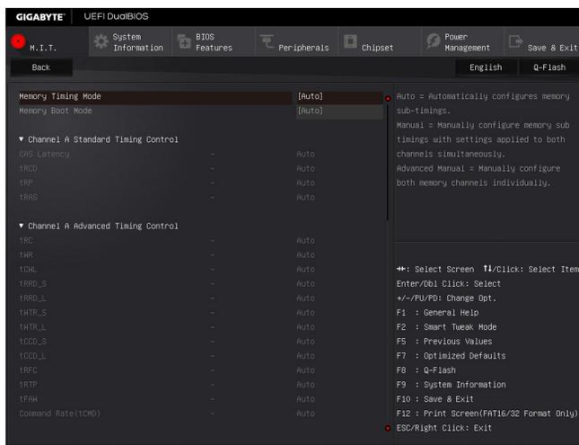
このサブメニューでは、メモリの各チャンネルのメモリ タイミング設定を行います。このサブメニューでは、メモリの各チャンネルのメモリ タイミング設定を行います。タイミング設定の各画面は、**Memory Timing Mode** が **Manual** または **Advanced Manual** の場合のみ設定可能です。注:メモリのタイミングを変更後、システムが不安定になったり起動できなくなることがあります。その場合、最適化された初期設定を読み込むかまたは CMOS 値を消去することでリセットしてみてください。
