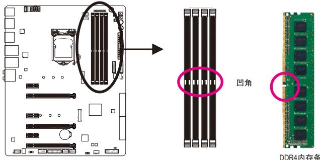
DDR4内存条上有一个凹角，只能以一个方向安装至内存条插槽内。请依下列步骤将内存条正确地安装于主板的内存插槽内。
