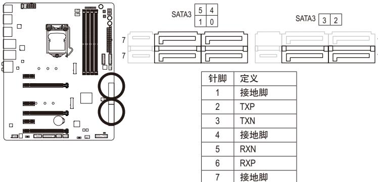
若要启动热插拔功能，请参考第二章「BIOS程序设置」－「Peripherals\SATA Configuration」的说明。
