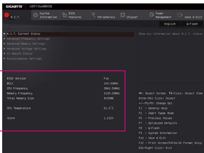
此画面提供BIOS版本、CPU基频、CPU时钟、内存时钟、内存总容量、CPU温度、CPU电压等相关信息。
