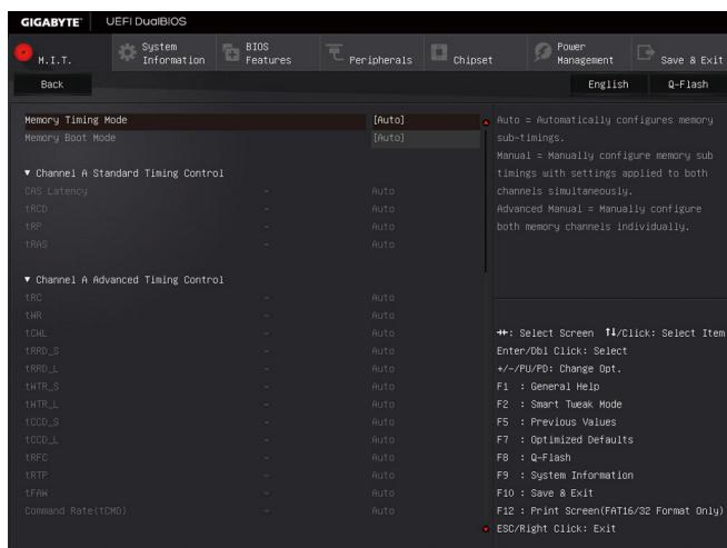
此画面可让您调整每一通道内存的时序。这些选单只有在「Memory Timing Mode」设为「Manual」或「Advanced Manual」时，才能开放设定。请注意！在您调整完内存时序后，可能会发生系统不稳或不开机的情况，您可以载入最佳化设定或清除CMOS设定值数据，让BIOS设定恢复至预设值。
