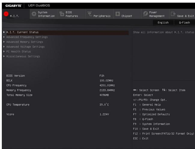
このセクションは、BIOS バージョン、CPU ベースクロック、CPU 周波数、CPU 周波数、メモリ周波数、合計メモリサイズ、CPU 温度、CPU 電圧などの情報を提供します。
