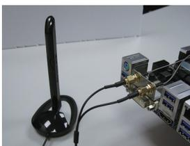
アンテナケーブルをアンテナコネクターに接続し、信号の強いところへアンテナを移動します。
