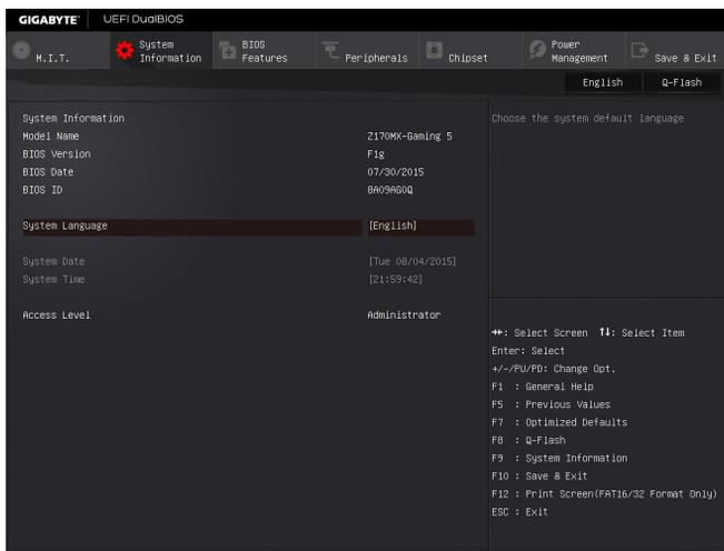
このセクションでは、マザーボードモデルおよび BIOS バージョンの情報を表示します。また、BIOS が使用する既定の言語を選択して手動でシステム時計を設定することもできます。
