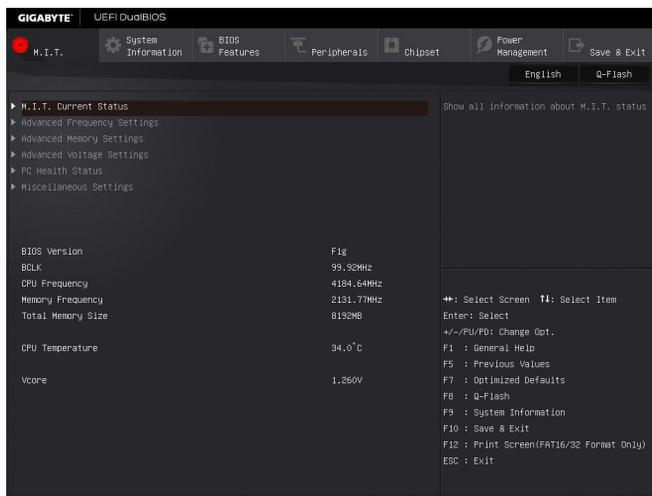
このセクションは、BIOS バージョン、CPU ベースクロック、CPU 周波数、メモリ周波数、合計メモリサイズ、CPU 温度、CPU 電圧などの情報を提供します。
