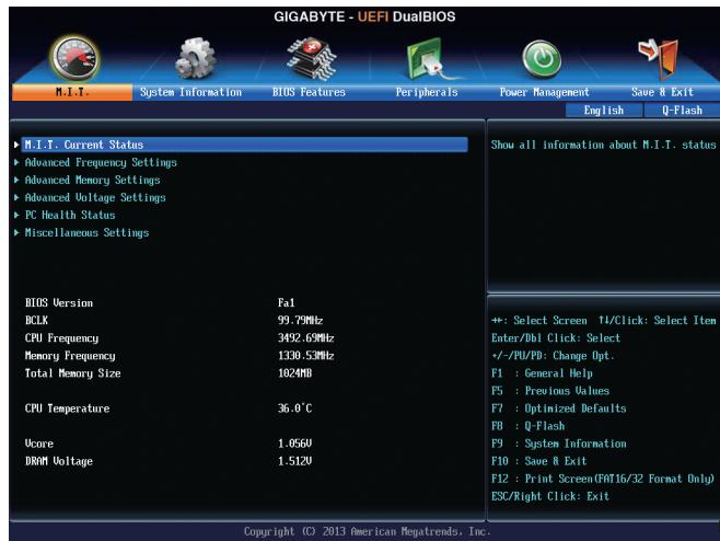
此画面提供BIOS版本、CPU基频、CPU时钟、内存时钟、内存总容量、CPU温度、Vcore和内存电压的相关信息。
