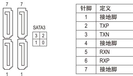
若要启动热插拔功能，请参考第二章「BIOS程序设置」－「Peripherals\ SATA Configuration」的说明。
