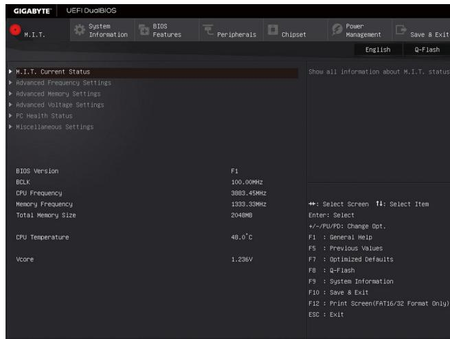
此画面提供BIOS版本、CPU基频、CPU时钟、内存时钟、内存总容量、CPU温度、CPU电压等相关数据。
