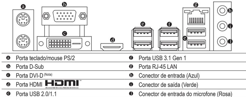
(Nota) A porta DVI-D port não suporta conexão D-Sub por adaptador.
