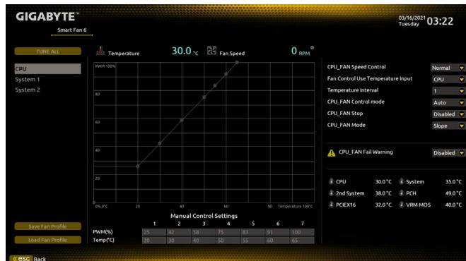
请利用功用键<F6>快速切换至此页面。在此页面您可针对各风扇插座调整转速相关设置，或查看系统/CPU温度。
