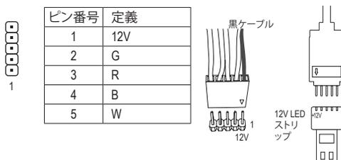
ヘッダに接続したRGB (RGBW) LEDストリップ延長ケーブルと反対側のRGB (RGBW) LEDストリップケーブルに接続します。延長ケーブルの(プラグの三角印)の黒線は、このヘッダのピン1 (12V) に接続する必要があります。延長ケーブルのもう一方の端(矢印マーク)の12Vピンは、LEDストリップの12Vと接続しなければなりません。誤って接続した場合は、LEDストリップの損傷につながる可能性があります。LEDストリップの接続方向にご注意ください。
