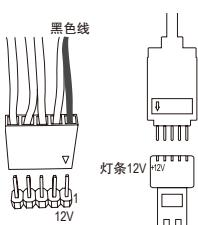
请将RGB(RGBW) LED灯条延长线接口接至此插座，另一端接至RGB(RGBW) LED灯条。延长线黑色线(接口上三角型标示)需连接至此插座的针脚1 (12V)，另一端的12V (接口上箭头标示)需连接至LED灯条的12V。安装时务必注意LED灯条的插法，不正确安装将会造成灯条烧毁。
