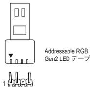
Addressable RGB Gen2 LEDテープをヘッダに接続します。LEDテープ側の電源ピン (プラグの三角印)をaddressable LEDテープヘッダのピン1に接続する必要があります。誤って接続すると、LEDテープが損傷する可能性があります。
