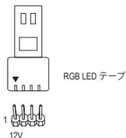
RGB LEDテープをヘッダに接続します。LEDテープの電源ピン (プラグの三角印)は、このヘッダのピン1 (12V)に接続する必要があります。誤って接続すると、LEDテープが損傷する可能性があります。
