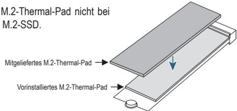
Folgen Sie den nachstehenden Schritten, um eine M.2-SSD richtig im M.2-Anschluss zu installieren.
