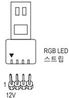
RGB LED 스트립을 헤더에 연결합니다. LED 스트립의 전원 핀(플러그에 삼각형이 표시되어 있음)을 이 헤더의 핀 1(12V)에 연결해야 합니다. 잘못 연결하면 LED 스트립이 손상될 수 있습니다.
