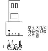
주소 지정이 가능한 LED 스트립을 헤더에 연결합니다. LED 스트립의 전원 핀(플러그에 삼각형이 표시되어 있음)을 주소 지정이 가능한 LED 스트립 헤더의 핀 1에 연결해야 합니다. 잘못 연결하면 LED 스트립이 손상될 수 있습니다.
