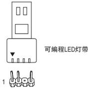
请将可编程LED灯带接至此插座。安装时请将灯带的电源接脚(接口上三角形标示)连接至插座的接脚1，不正确安装将会造成灯带烧毁。
