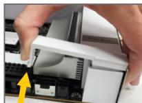
**注意!** 连接 12V 电源插座前, 请先依左图指示移除 CPU 藏线盖。以手指轻轻按压 CPU 藏线盖前端并将它向上拉起后移除。
