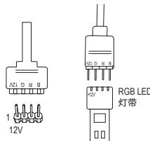
请将RGB LED灯带延长线接口接至此插座，另一端接至RGB LED灯带。延长线黑色线(接口上三角形标示)需连接至此插座的接脚1 (12V)，另一端的12V (接口上箭头标示)需连接至LED灯带的12V。安装时务必注意LED灯带的插法，不正确安装将会造成灯带烧毁。
