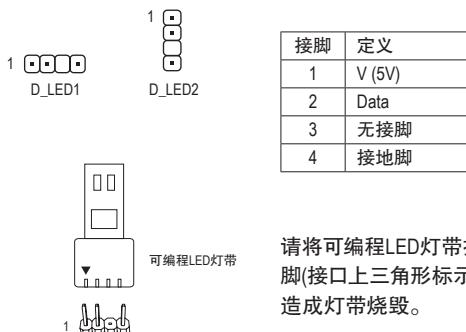
请将可编程LED灯带接至此插座。安装时请将灯带的电源接脚(接口上三角形标示)连接至插座的接脚1, 不正确安装将会造成灯带烧毁。
