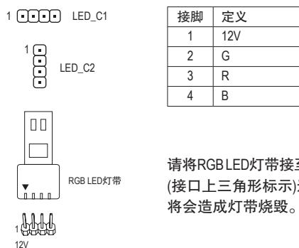
请将RGB LED灯带接至此插座。安装时请将灯带的电源接脚(接口上三角形标示)连接至插座的接脚1(12V)，不正确安装将会造成灯带烧毁。
