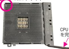
CPUソケットロックレバーを完全に持ち上げます。
