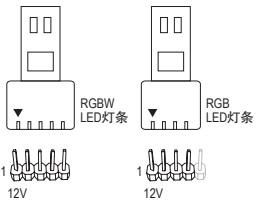
请将RGB (RGBW) LED灯条接至此插座。安装时请将灯条的电源针脚(接口上三角形标示)连接至插座的针脚1 (12V)，不正确安装将会造成灯条烧毁。
