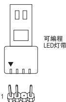
请将可编程LED灯带接至此插座。可编程LED灯带分为5V及12V，请确认所使用的电压规格，并将DLED\_V\_SW1及DLED\_V\_SW2针脚调整为对应的电压。安装时请将灯带的电源接脚(接口上三角形标示)连接至插座的接脚1，不正确安装将会造成灯带烧毁。
