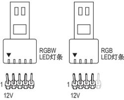
请将RGB (RGBW) LED灯条接至此插座。安装时请将灯条的电源针脚(接口上三角形标示)连接至插座的针脚1 (12V)，不正确安装将会造成灯条烧毁。
