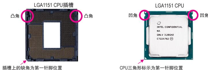
插槽上的缺角为第一针脚位置                           CPU三角形标示为第一针脚位置
