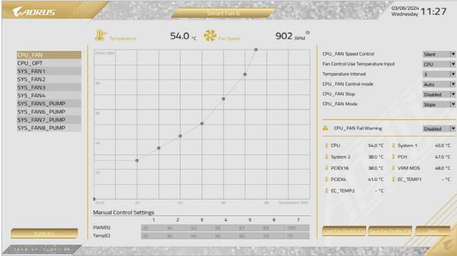
请利用功能键<F6>快速切换至此页面。在此页面您可针对各风扇插座调整转速相关设置，或查看系统/CPU温度。
