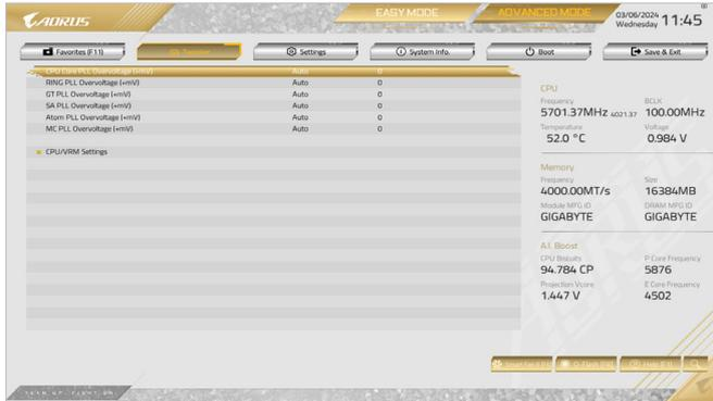
此画面可让您调整Load-Line Calibration幅度、过电压保护值、过电流保护值…等设置。
