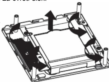
3 Ugradite disk u rešetku pomoću vijaka koje ste dobili i utaknite kabel SATA u disk.
