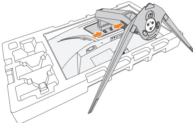
3. Осторожно потяните основание вниз, чтобы снять его с крючков. Снимите основание.
