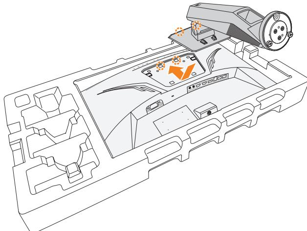
3. Совместите основание монитора с двумя направляющими шпильками на нижней стороне подставки. Закрепите подставку на основании.
