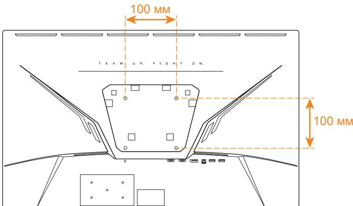
**Примечание.** Чтобы установить монитор на стене, руководствуйтесь инструкциями по установке к комплекту кронштейна для настенного монтажа.
