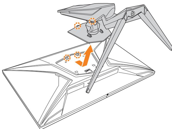
4. Attachez le support de montage sur les trous de montage à l'arrière du moniteur. Utilisez ensuite les vis pour fixer le support en place.
