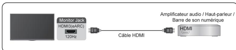
Cette fonction vous permet également de faire fonctionner le système audio à travers la télécommande de votre moniteur au lieu d'utiliser une télécommande pour chaque appareil.
