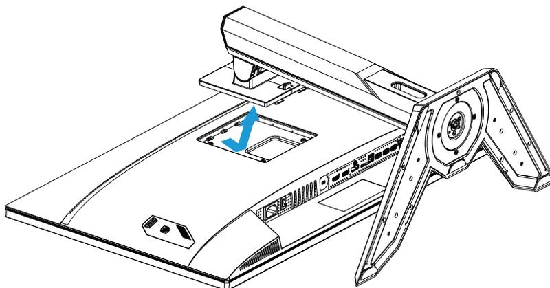
4. Fixe a braçadeira de montagem nos furos de montagem na parte posterior do monitor. Depois, use os parafusos fornecidos com o kit de montagem de parede para fixar o suporte no lugar.
