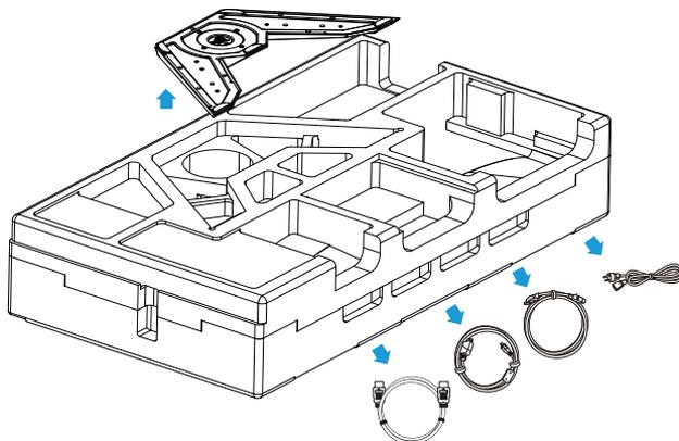
4. Remova a espuma EPS superior. Depois você pode remover o suporte da espuma EPS inferior.
