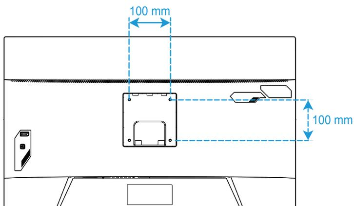
**Nota:** Para montar o monitor na parede, consulte o guia de instalação que está incluído no kit da braçadeira de montagem na parede. Tamanho do parafuso de montagem VESA: M4 x 15mm mínimo.
