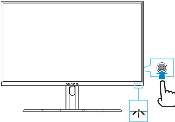
**Hinweis:** Falls kein Signal anliegt, zeigt der Monitor für einige Zeit die Meldung **No Signal**. Dann wechselt der Monitor in den Energiesparmodus und die Betrieb-LED blinkt weiß in Abständen von einer Sekunde.
