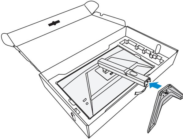
4. Levante el tornillo de anillo y gírelo en el sentido de las agujas del reloj para asegurar la base del monitor en su sitio.
