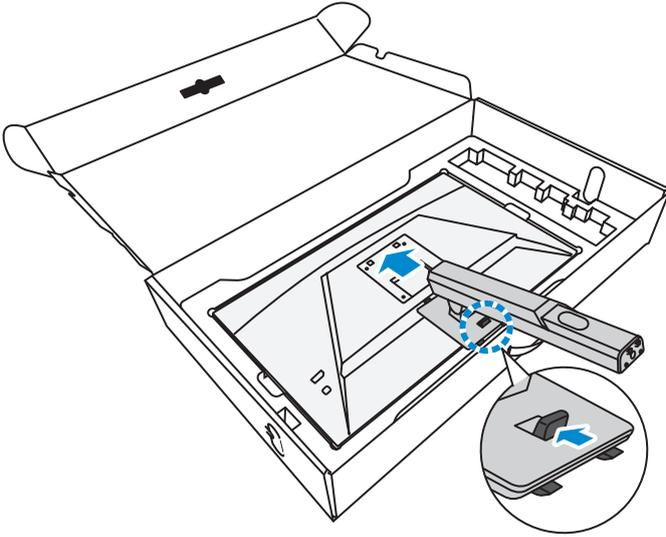
3. Alinee la base del monitor con el separador debajo del soporte. Luego coloque la base en el soporte.
