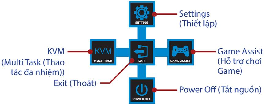
Sau đó sử dụng nút **Điều khiển** để chọn chức năng mong muốn và cấu hình các thiết lập liên quan.
