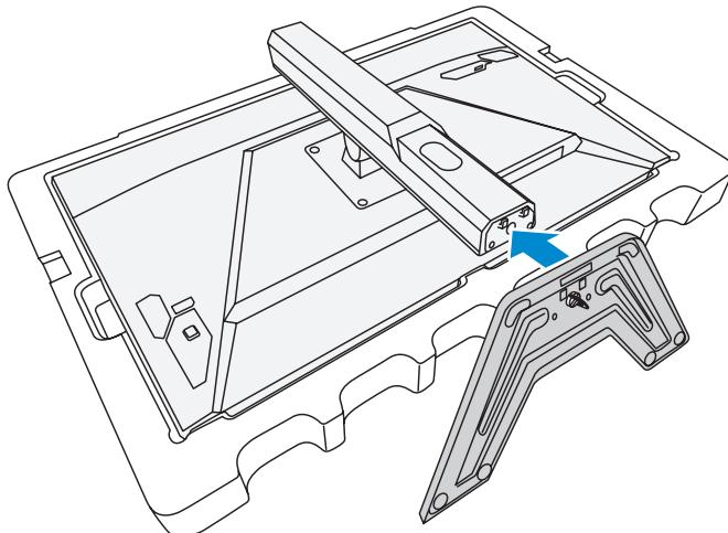
3. 提起螺丝环并顺时针拧动，将显示器底座固定到位。
