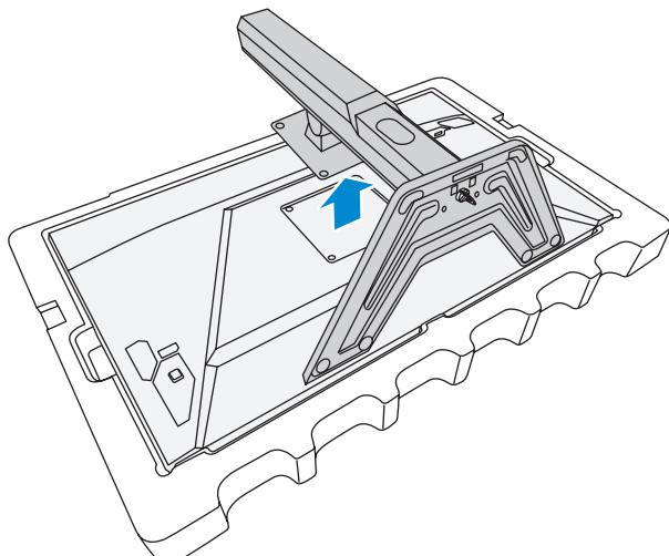
4. 将装配架连接到显示器背面的壁挂架螺丝孔中。然后用螺丝将装配架固定到位。
